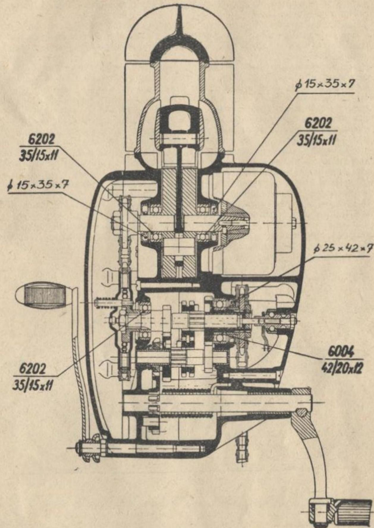
Рис. 5. Разрез двигателя 50 см<sup>3</sup> модели 555
