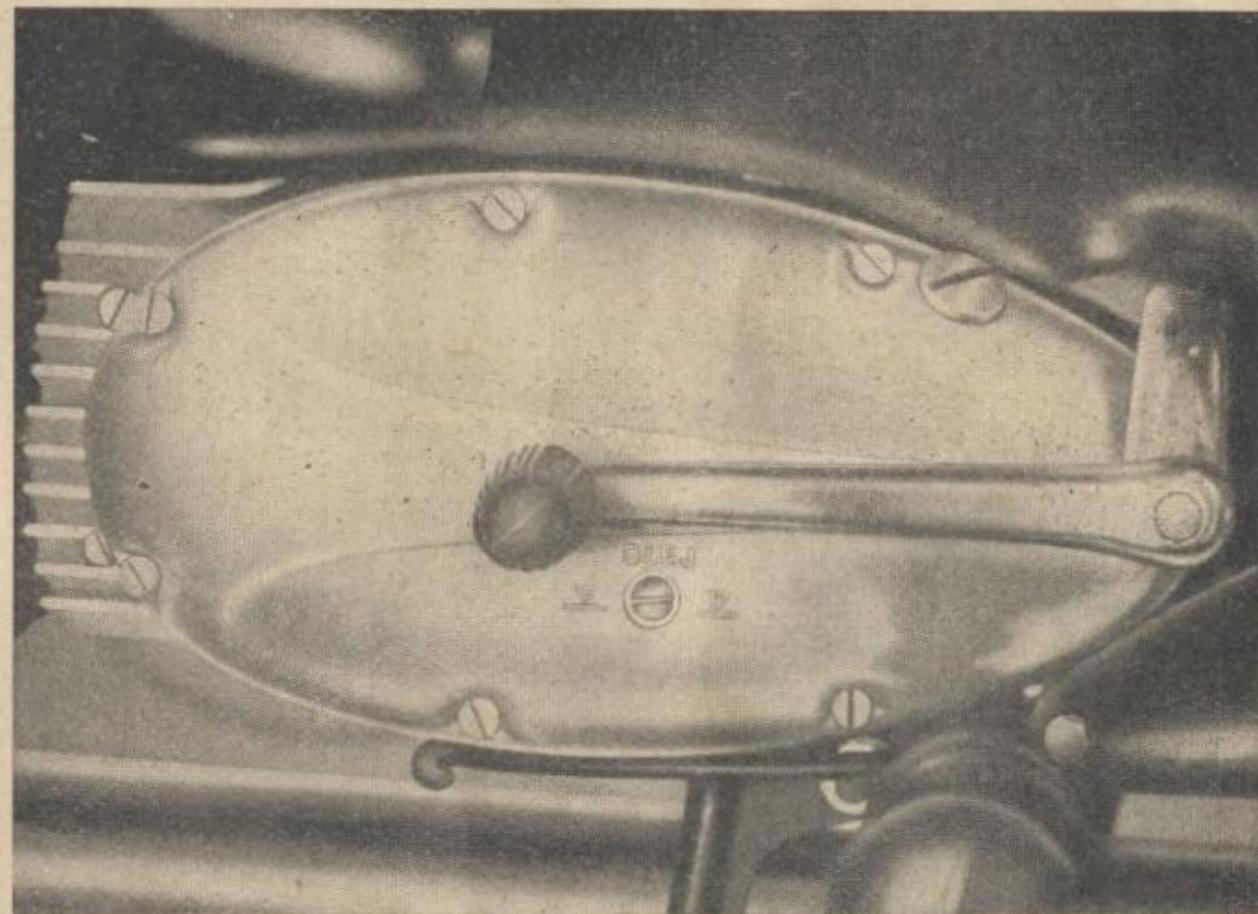
Рис. 8. Контрольно-заливное отверстие для масла и рычаг включения ступней передачи.
