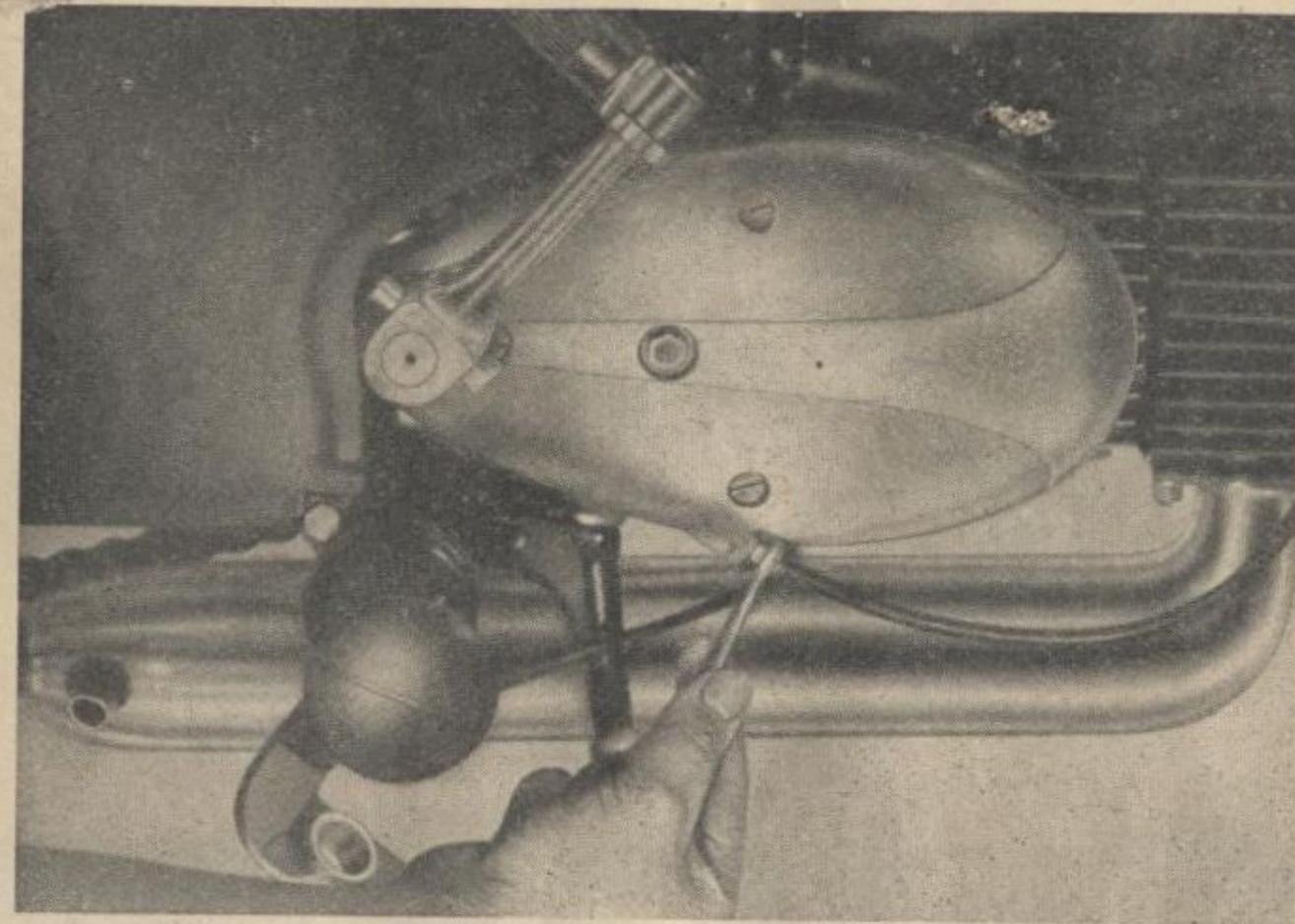
Рис. 19. Регулировка сцепления.
