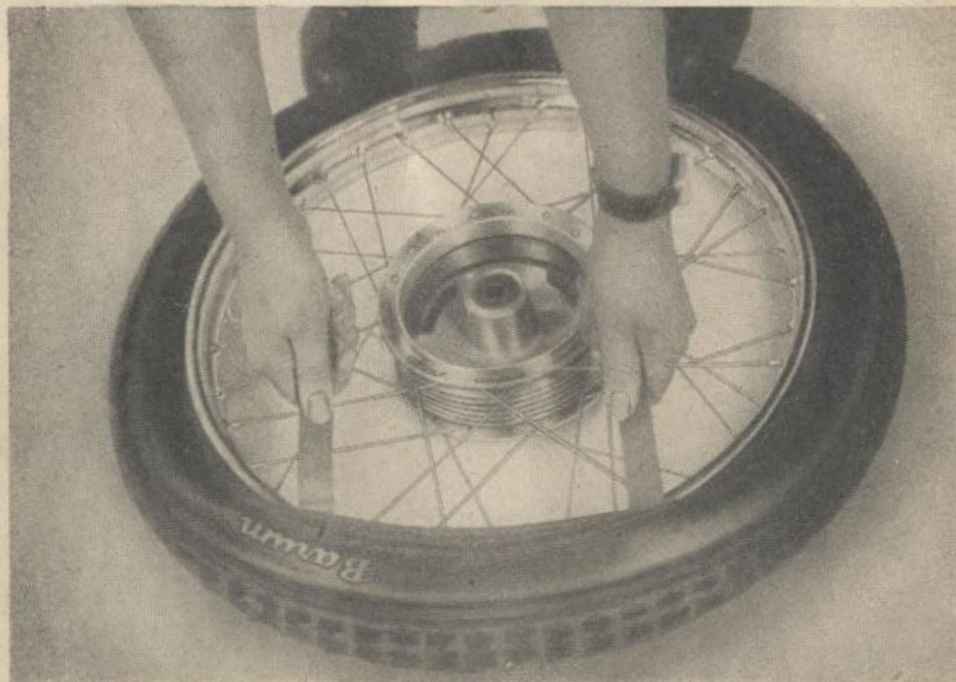
Рис. 16. Правильный монтаж шины.
