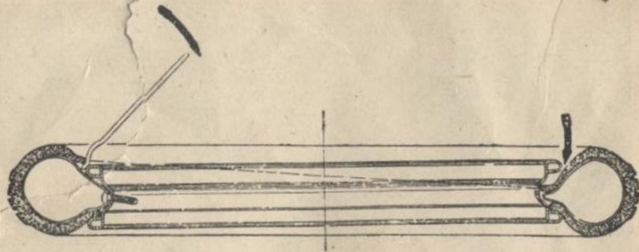
Рис. 15. Разрез обода колеса и шины.
