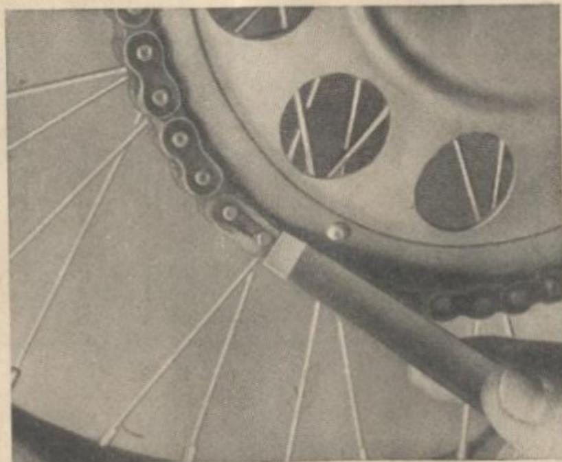
Рис. 17. Снятие замка цепи.
