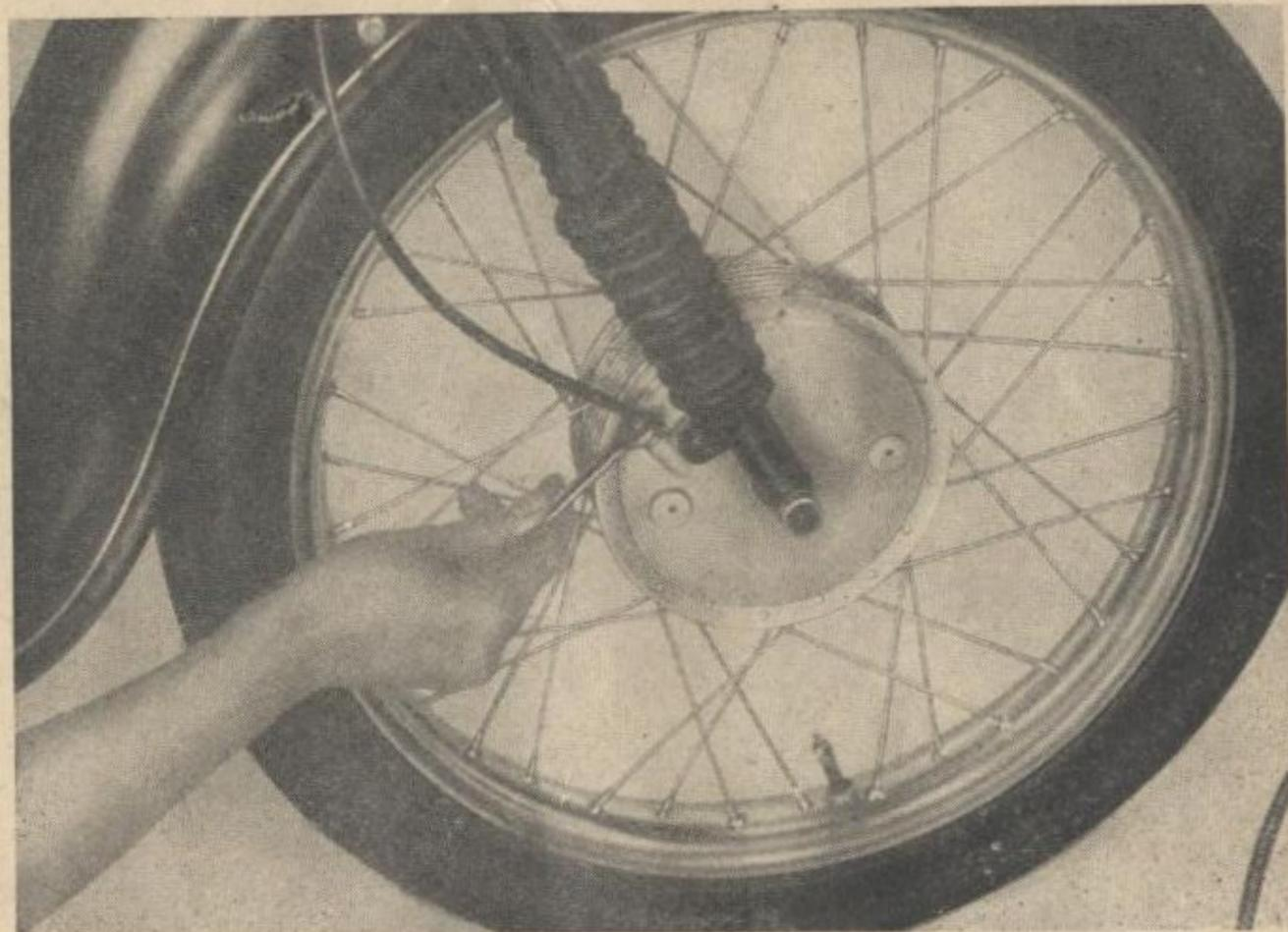
Рис. 18. Регулировка тормозов.
