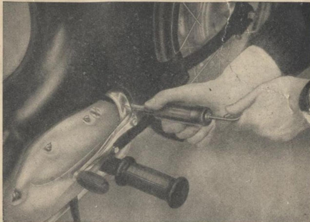
Рис. 13. Смазка задней вилки.
