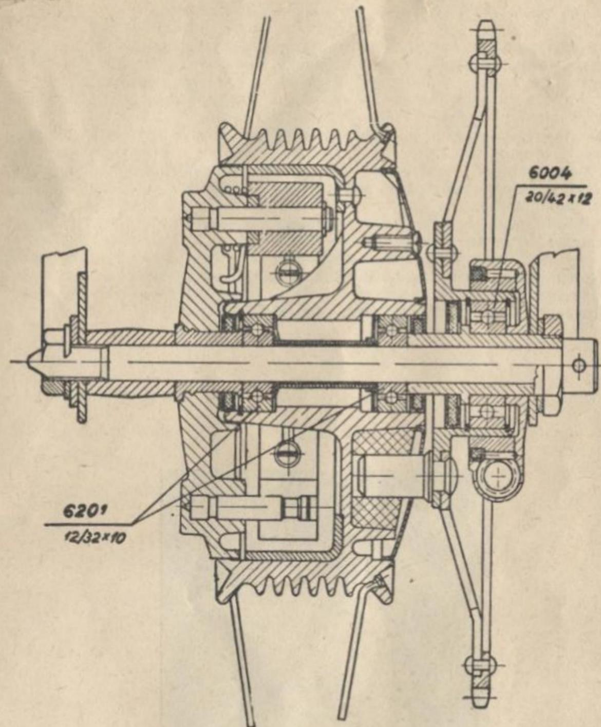
Рис. 24. Разрез заднего колеса
