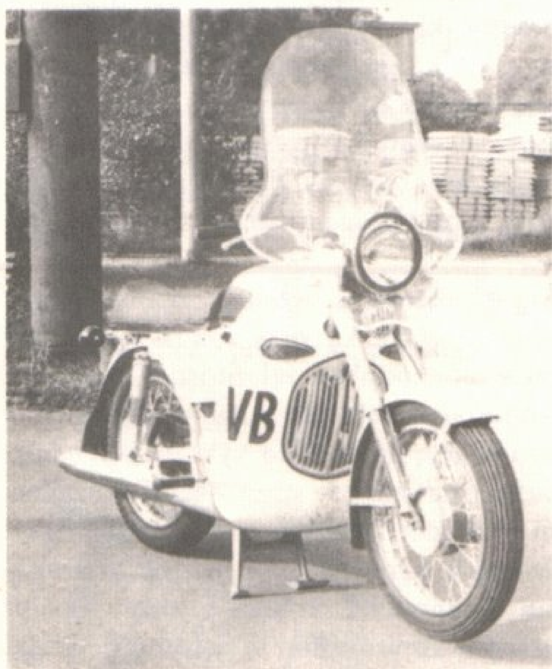
a) Příkladem motocyklu s účelnou kapotáží je Jawa 350 v úpravě pro VB, b), c) Nabídka kapotáží pro zahraniční cestovní motocykly
