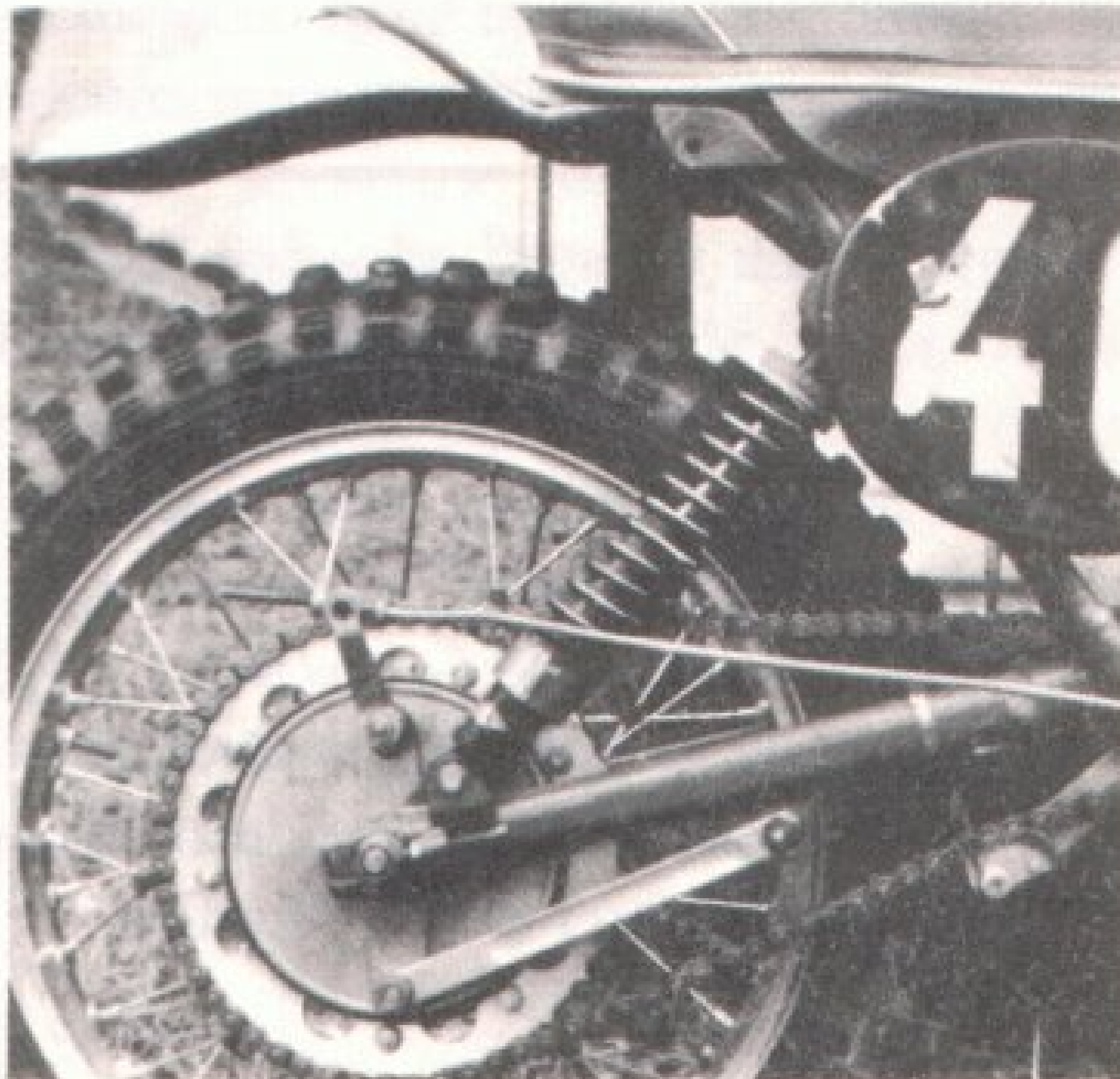
Příklad zvětšení zdvihu kola abnormálním sklonem pružicích jednotek
