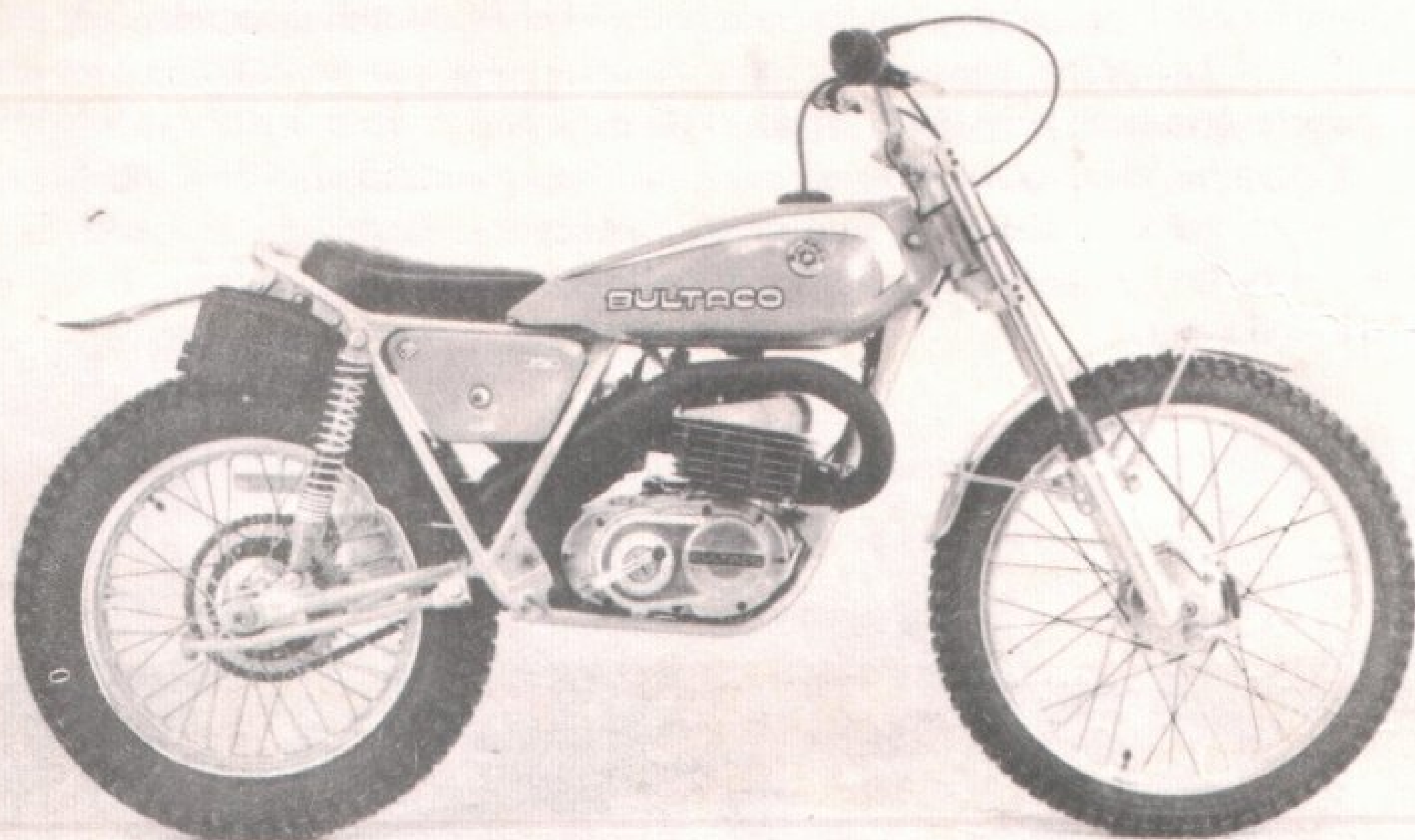
Typická stavba soutěžního motocyklu pro šlapačkové soutěže je patrná z obrázku stroje Bultaco Sherpa T 350
