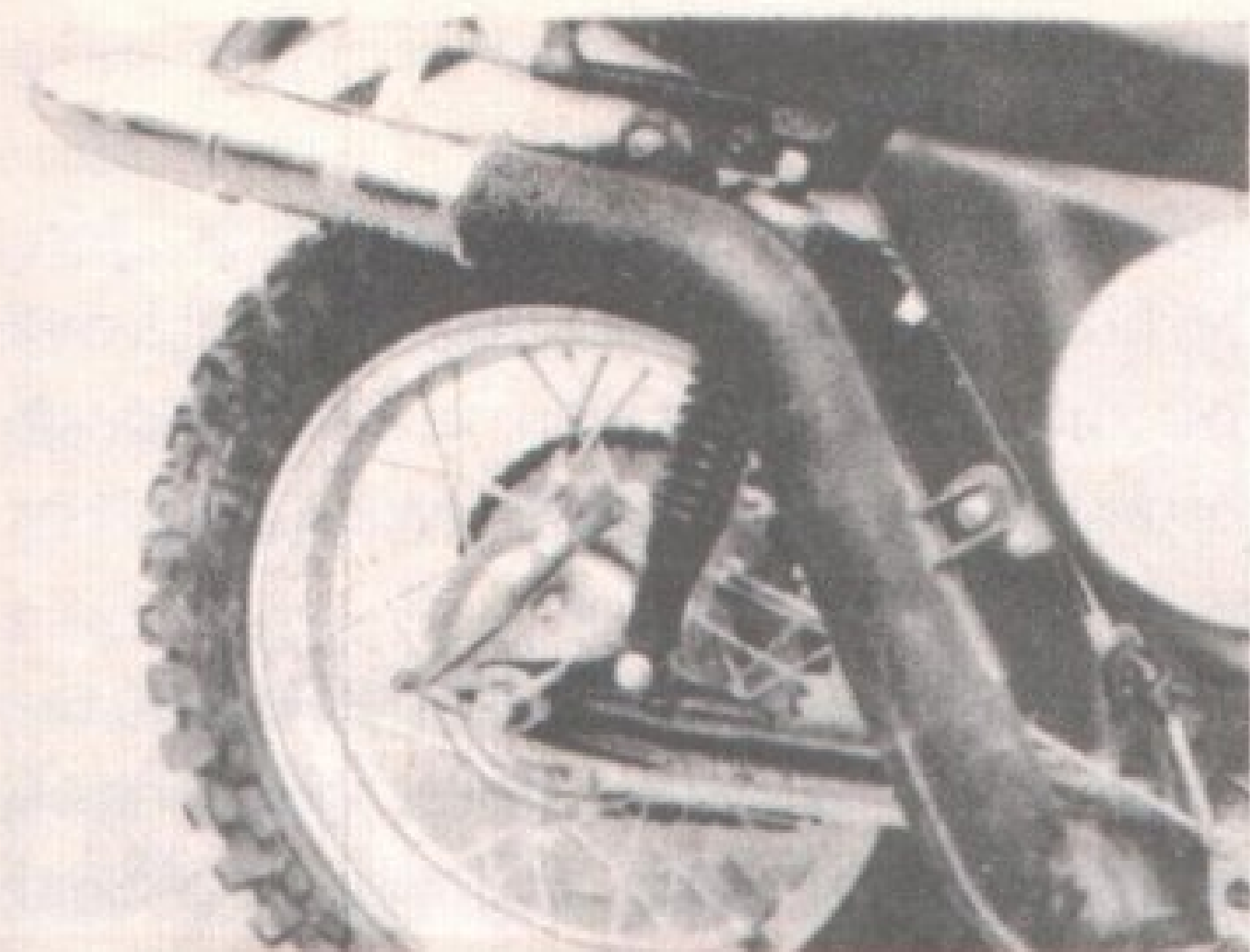
I na soutěžních motocyklech vychází často výfukové potrubí s účinným tlumičem hodně dlouhé
