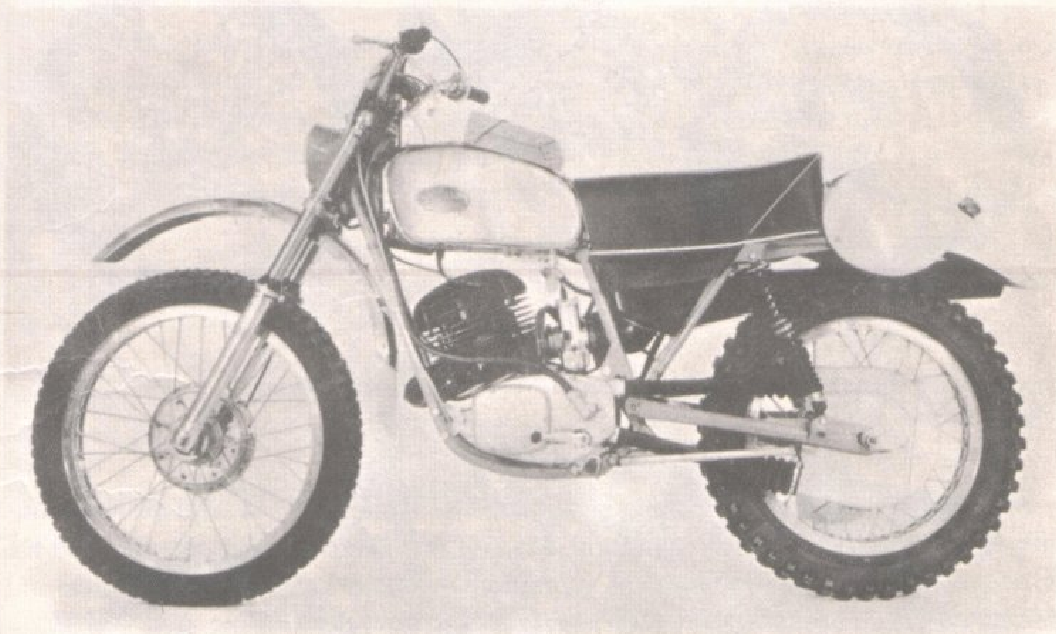
Soutěžní motocykly Jawa s dvoudobým jednoválcovým motorem s rozvodem pístem v lehkém trubkovém rámu, doplněném výborným odpružením, stojí na světové špičce
