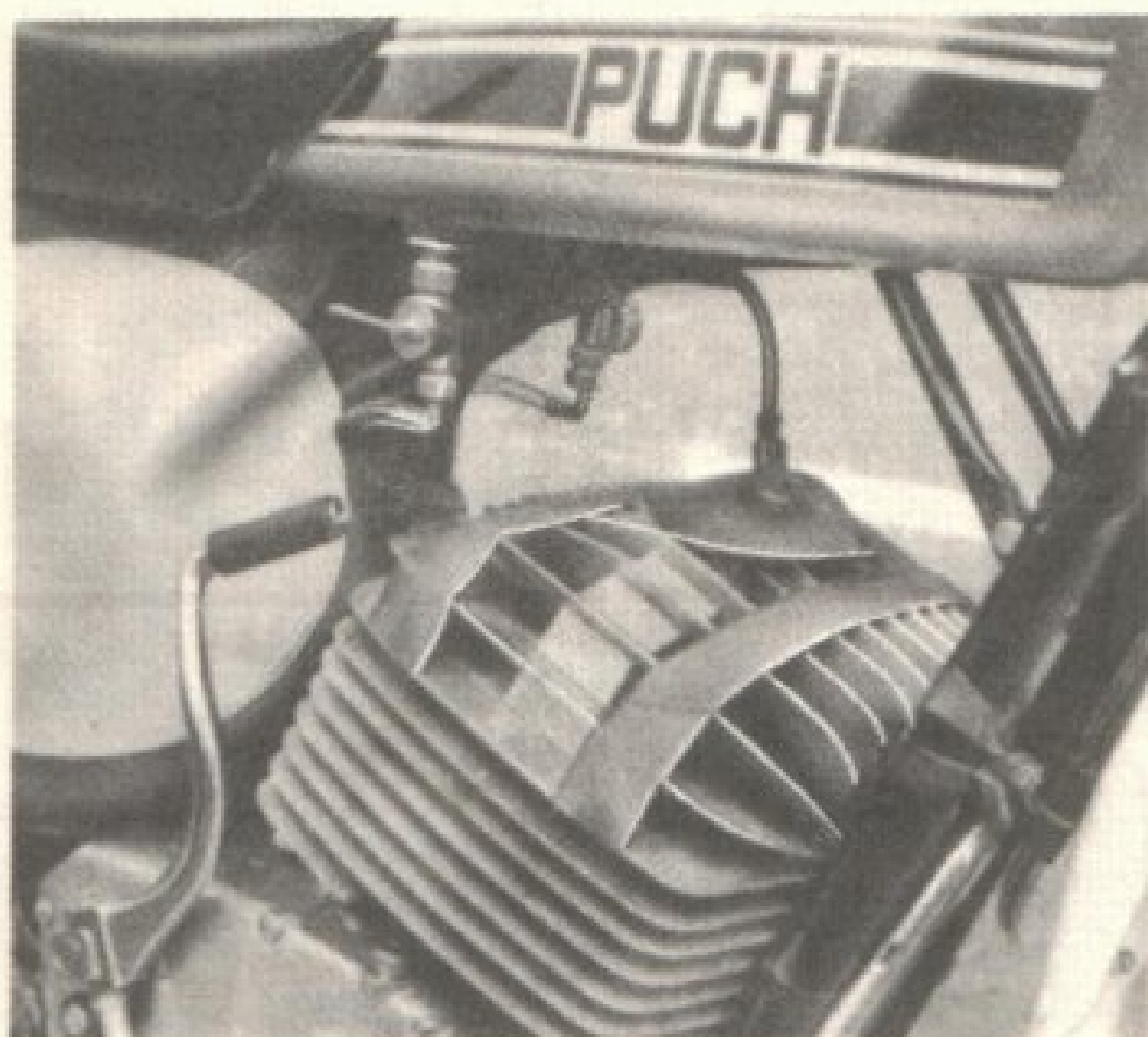
Vějířovité žebrování hlavy — spojení žeber prolitím je někdy ještě doplněno pryžovými pásky
