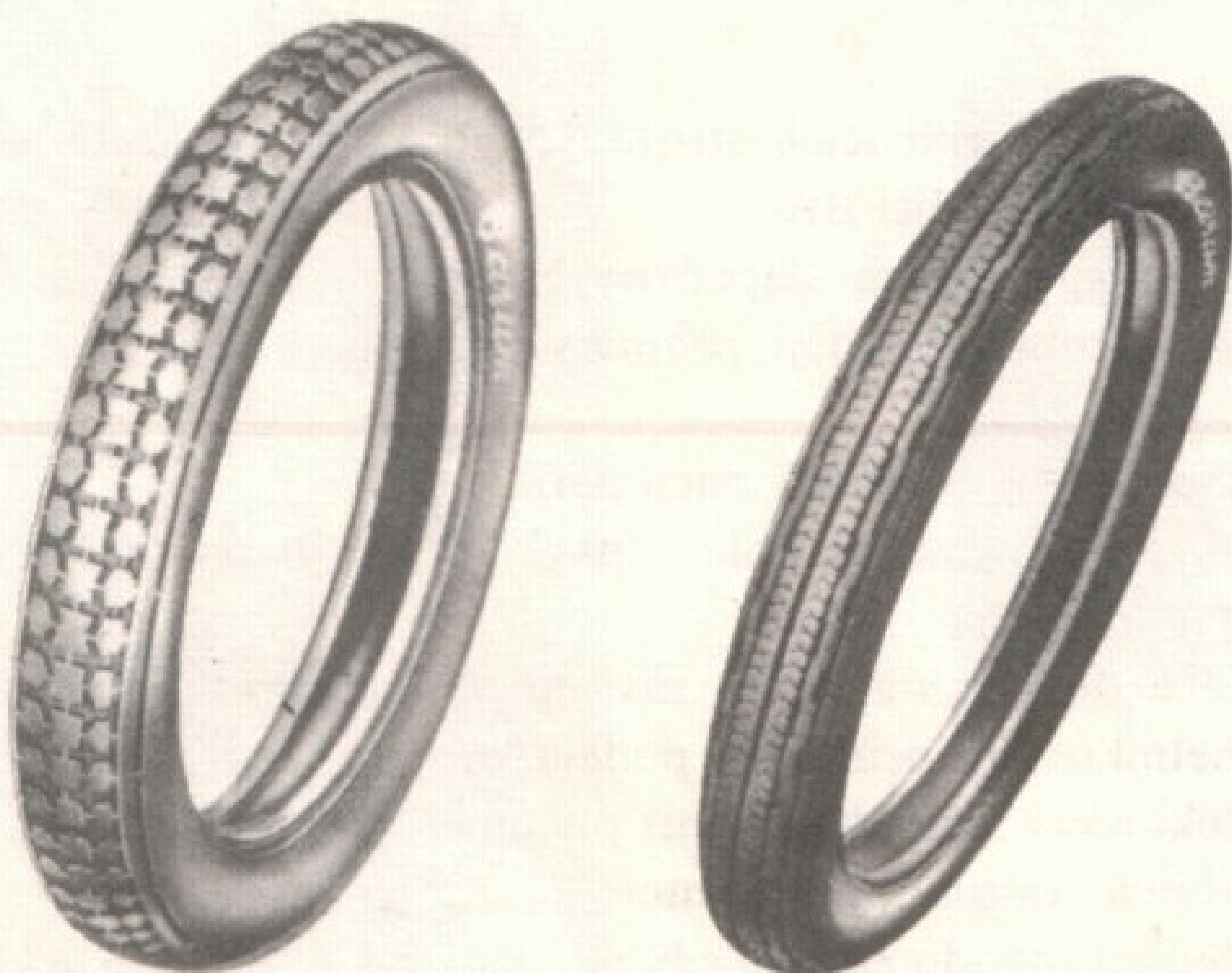
Pneumatiky Barum pro přední kolo cestovních motocyklů: vlevo vzorek M 5, vpravo M 10
