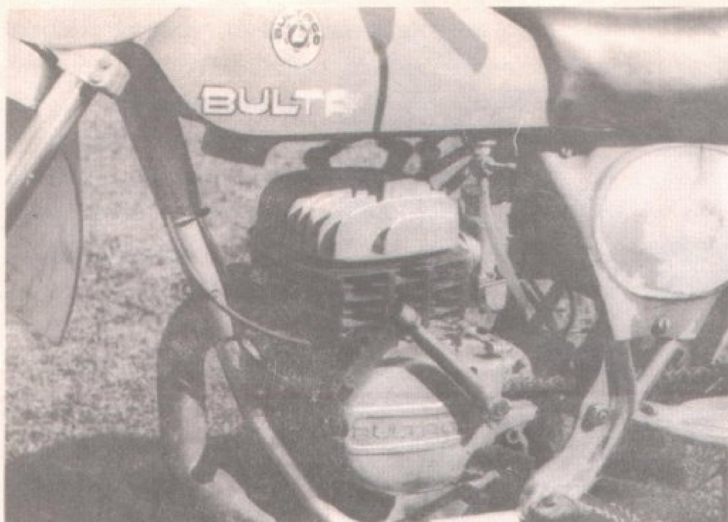
Terénní Bultaco 250 má motor s rozvodem sání pístem
