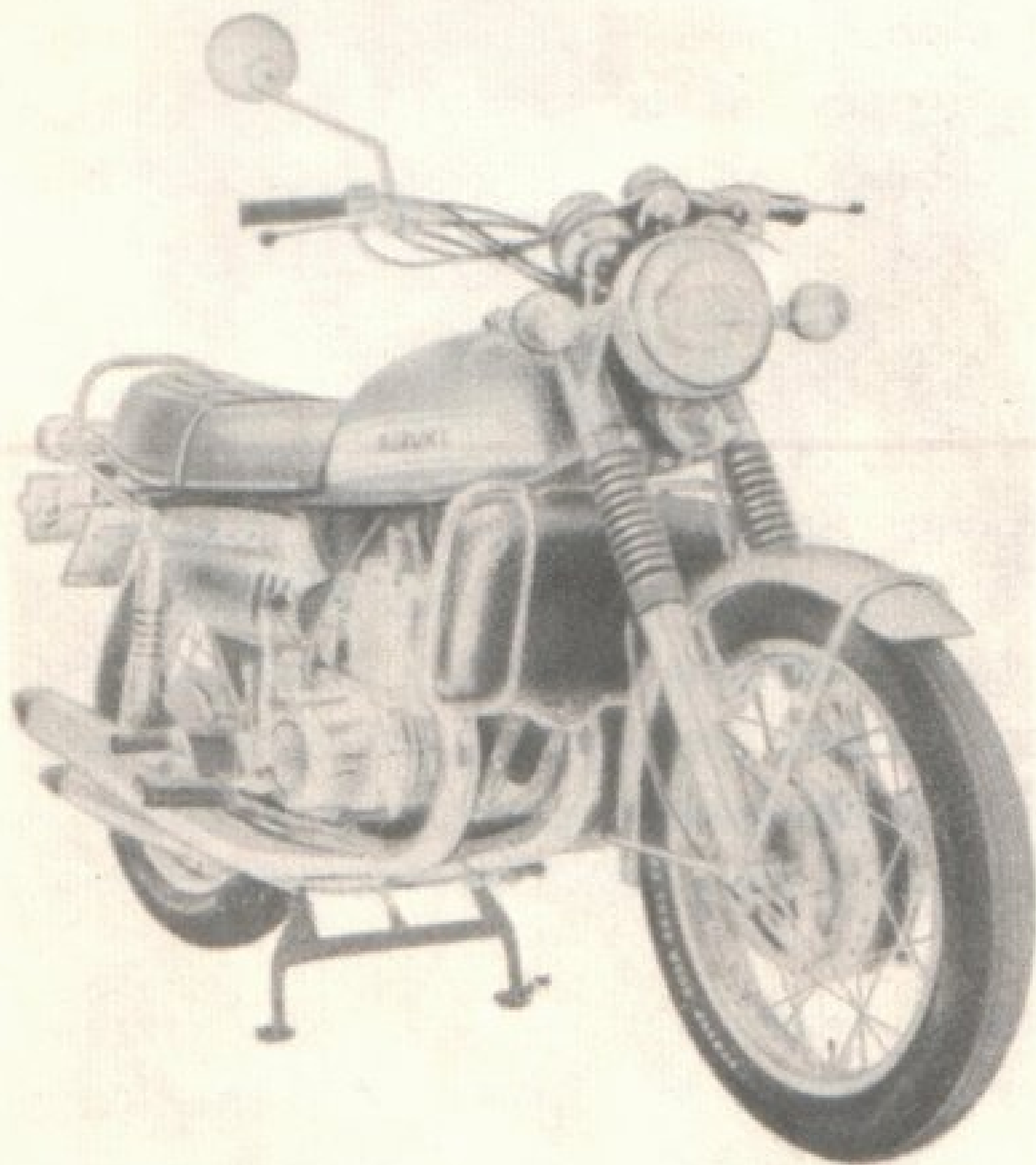
Vodou chlazený tříválec Suzuki 750 patří k dvoudobým velkoobjemovým strojům sportovního charakteru
