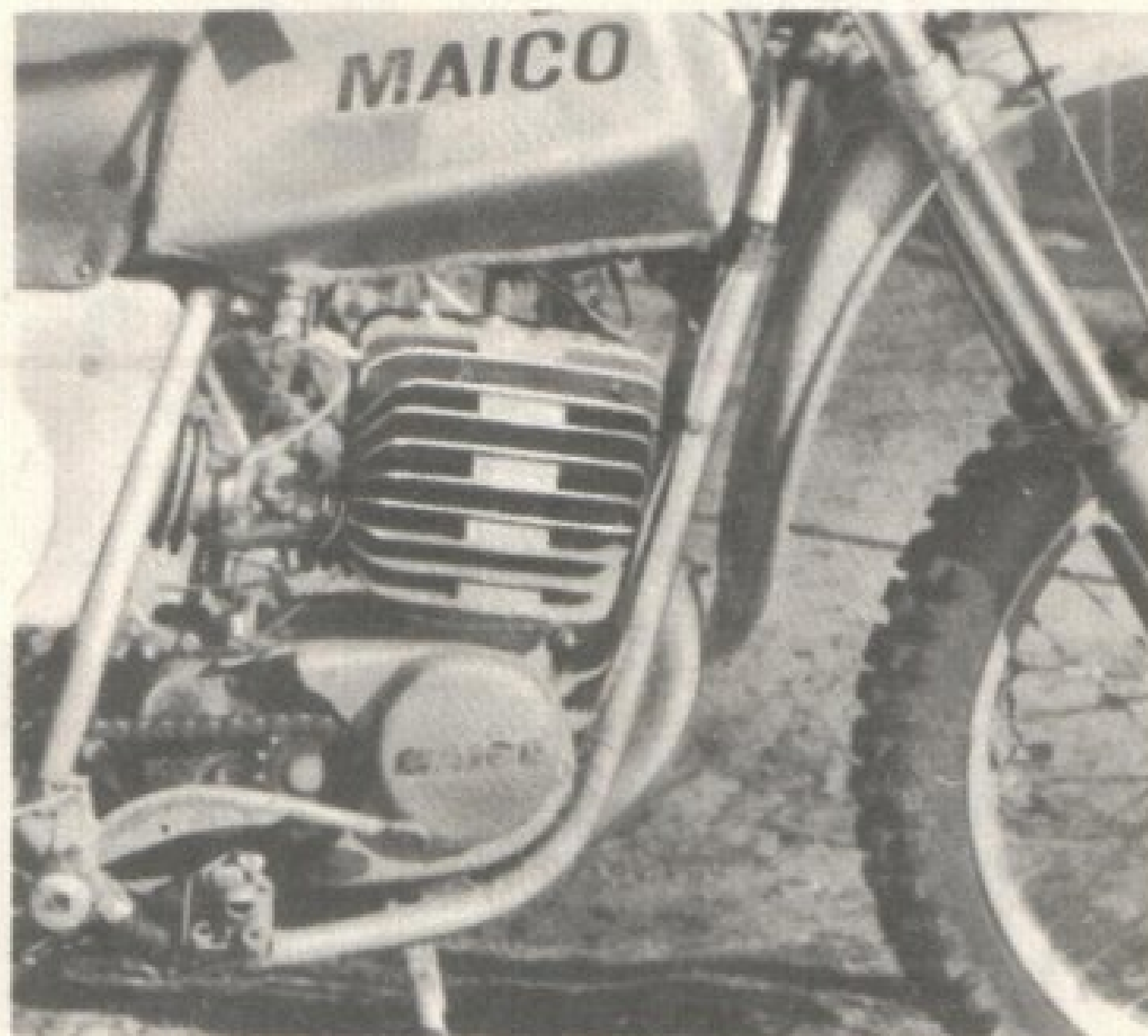
Solidní propojení žebër u motoru soutěžního motocyklu Maico
