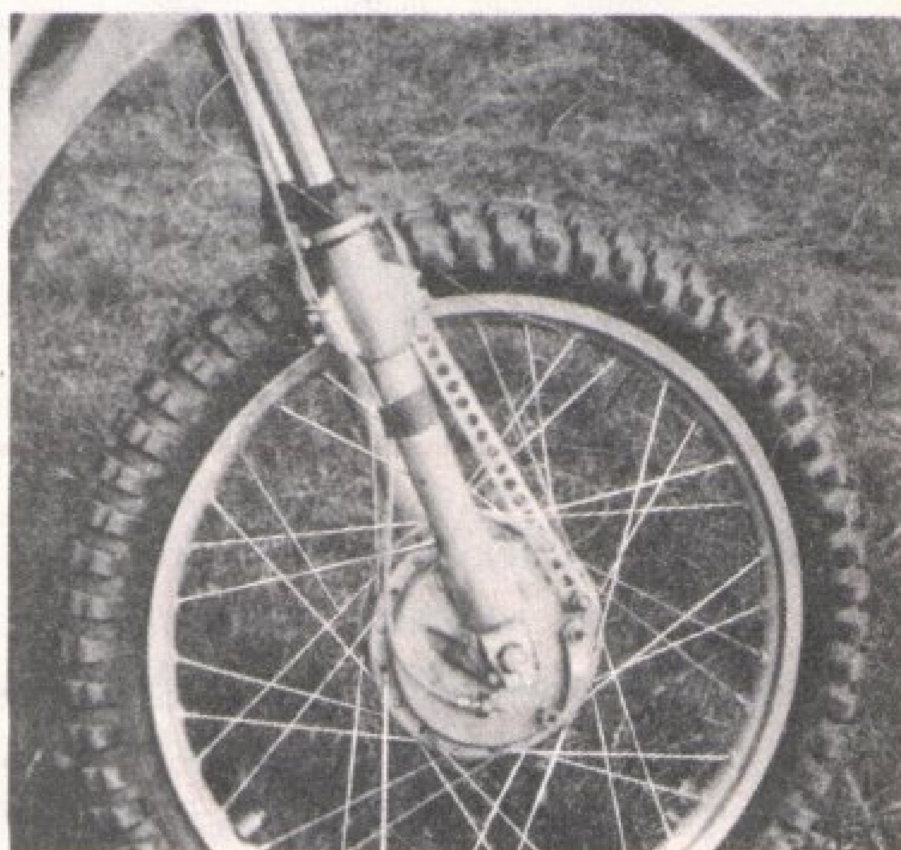
Záchyť reakce brzdy dlouhým táhlem snižuje ohybové namáhání a přičení kluzáku vidlice
