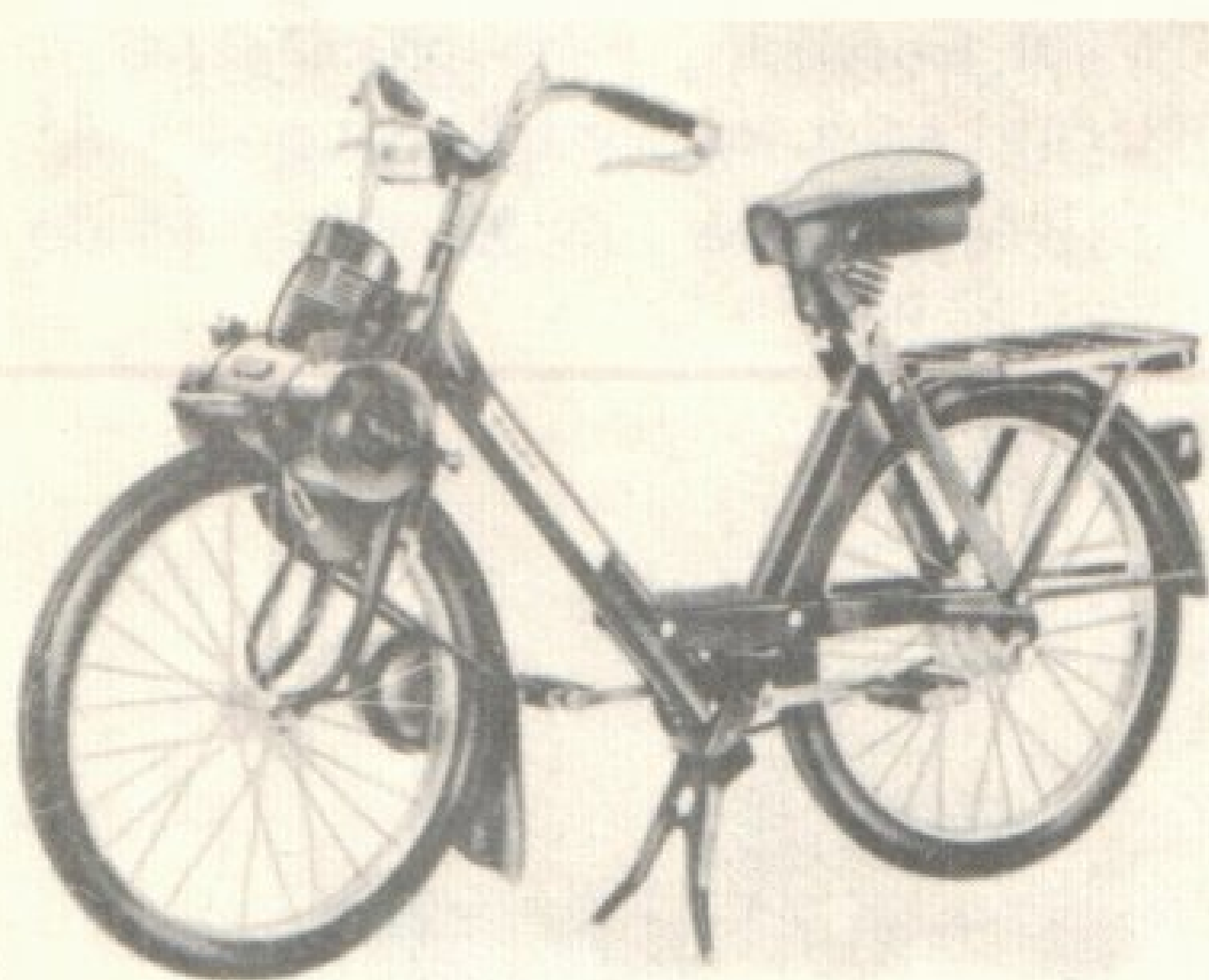
K nejlevnějším a nejjednodušším typům jednostopých motorových vozidel patří Velosolex
