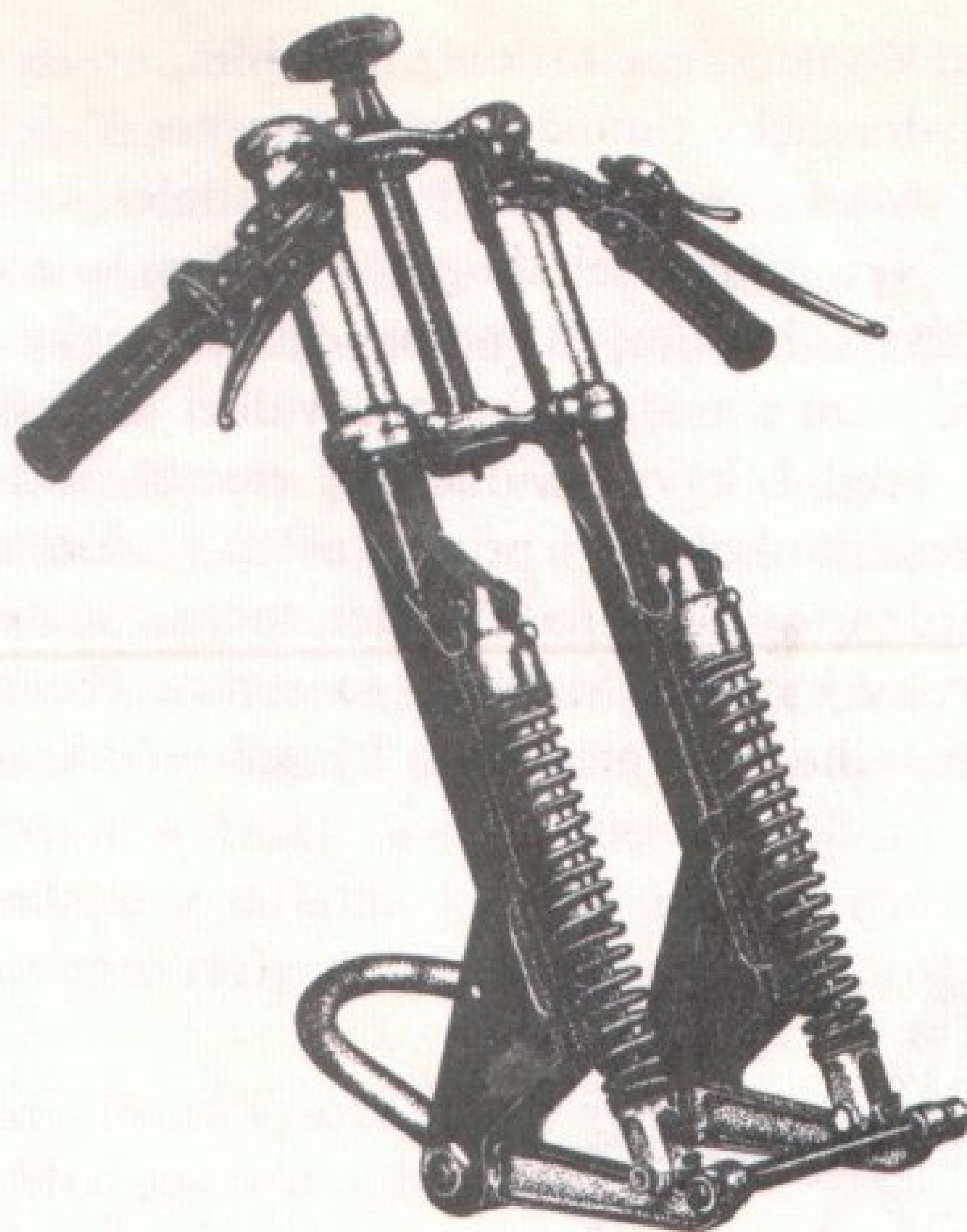
Kyvná vidlice s krátkým sunutým ramenem — silniční závodní ČZ z roku 1958
