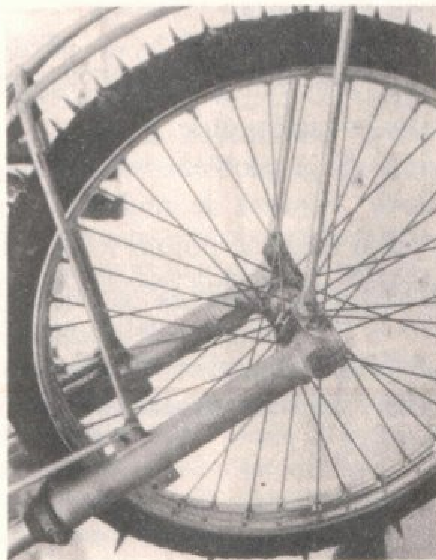
Zcela zvláštní úpravu pneumatik mají plochodrážní motocykly pro ledové tratě — jsou vybaveny ostrými ocelovými hroty předepsané délky 28 mm
