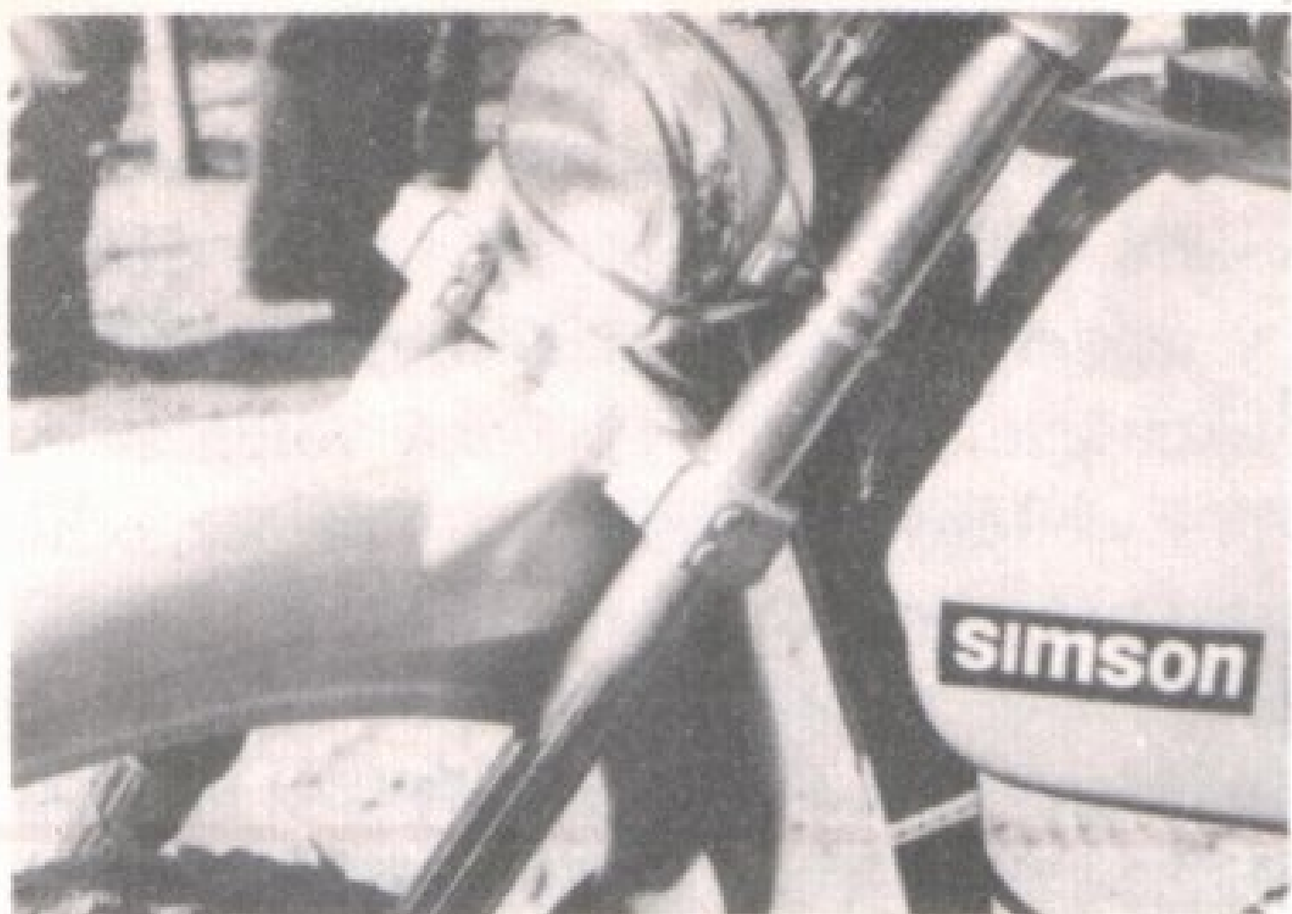
Zvláštní tvarování předního odpruženého blatníku pomáhá k jeho spolehlivému upevnění
