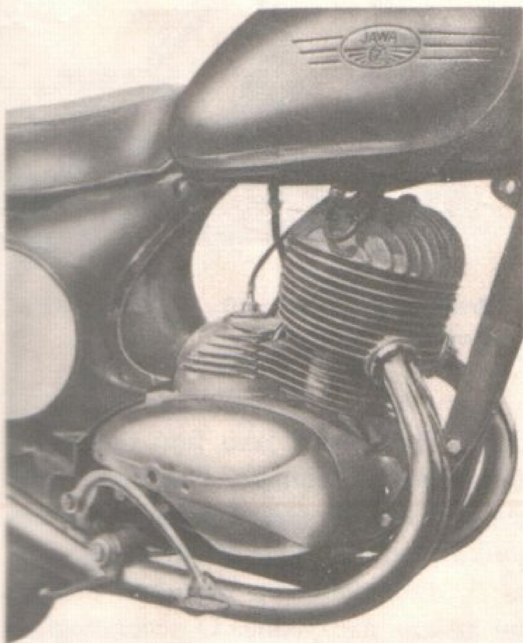
Úspěšný jednoválcový dvoudobý motor Jawa 250 se stává na dlouhou dobu základem pro stavbu mnoha motocyklů různých typů. Na obr. úspěšná terénní dvěstěpadesátka
