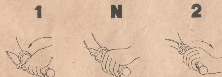
Фиг. 7. Включение передач.
