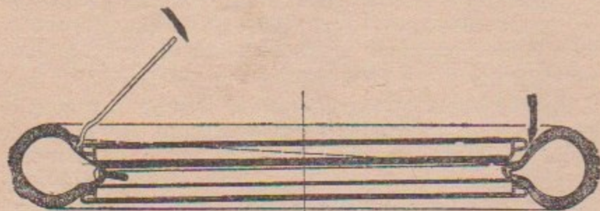
16. Rez ráfikom a pneumatikou — montáž pneumatiky
